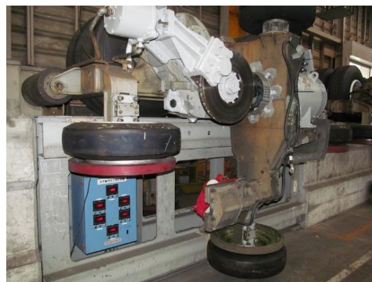
台車整備（水平輪押付力測定）
